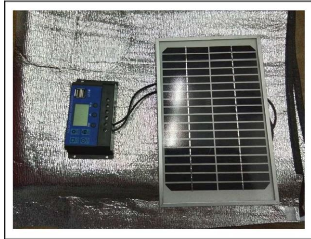
Rajah 24 : Controller Tidak Berfungsi
