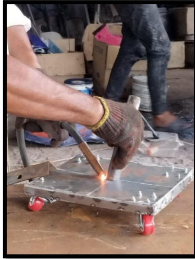
Rajah 3. 7. 5: Mengimpal plat besi dan rod tiang.
