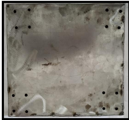
Rajah 3. 7. 2: Menebuk lubang skru di plat besi untuk penyambungan roda.
