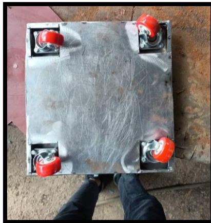
Rajah 3. 7. 4: 4 unit roda disambungkan ke plat besi.
