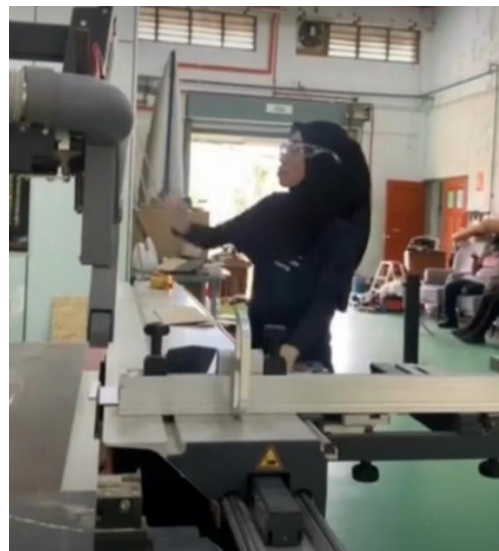
Rajah 3.10 Kerja pemotongan papan lapis
