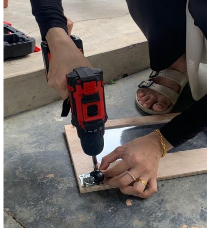
Rajah 3.13 pemasangan roda
