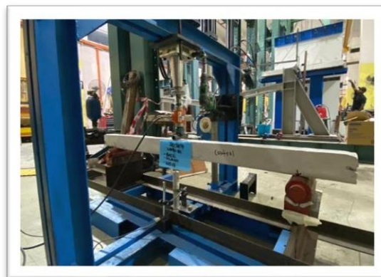
Rajah 3.9 : merupakan proses ujian lenturan.
