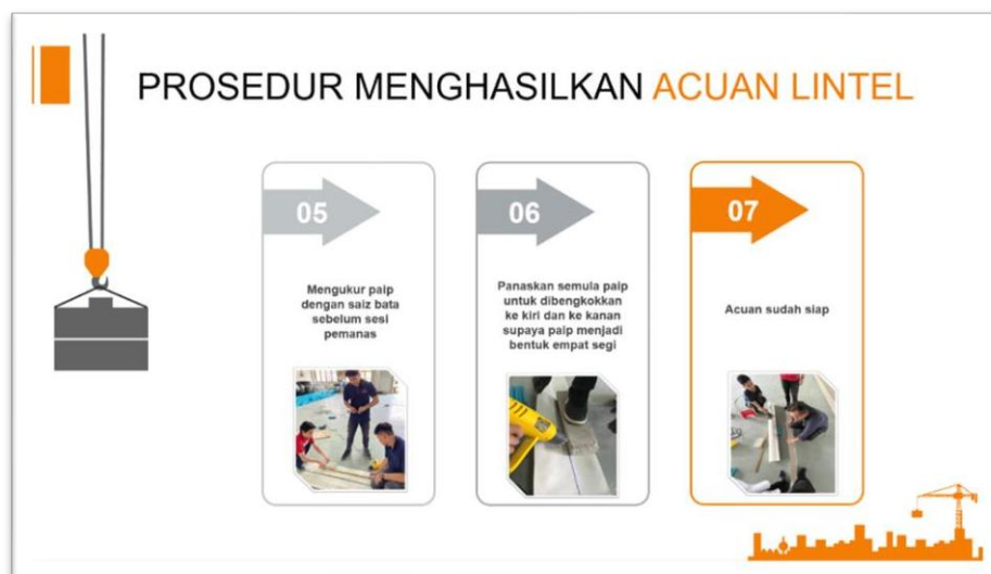
Rajah di atas merupakan Prosedur Penghasilan Acuan Lintel.
