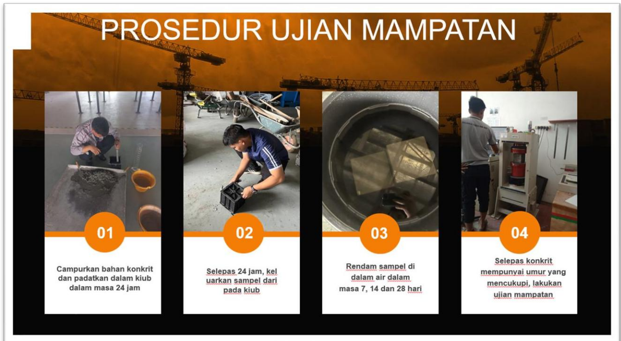
Rajah di atas merupakan Prosedur Ujian Mampatan
