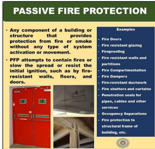
Rajah 9 Komponen Sistem Perlindungan Kebakaran Pasif
