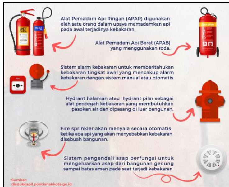
Rajah 8: Komponen Sistem Perlindungan Kebakaran Aktif
