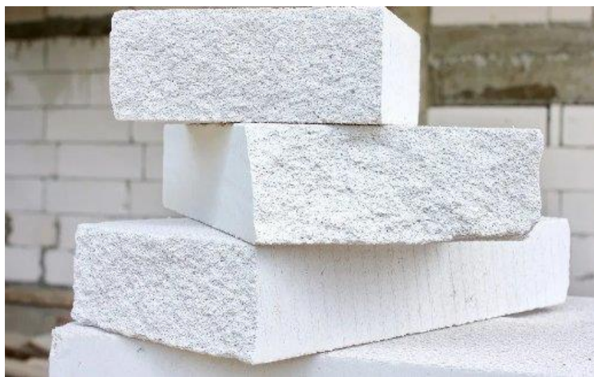
Rajah 2.3: Batu Bata Pasir Kapur (Kalsium Silikat)
