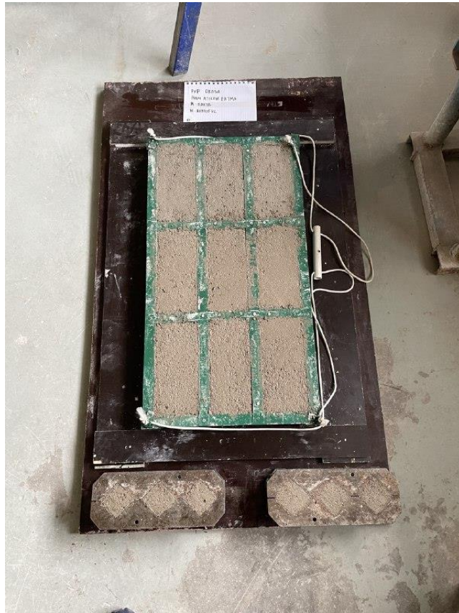
Rajah 3.11: Bancuhan yang telah dipadatkan dalam acuan
