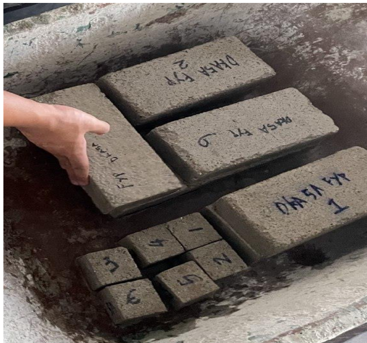
Rajah 3.13: Sampel bata simen yang dihasilkan di makmal
