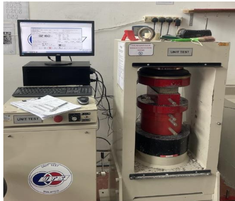
Rajah 3.14: Ujian kekuatan mampatan yang dilakukan di RTL Lab, Subang
