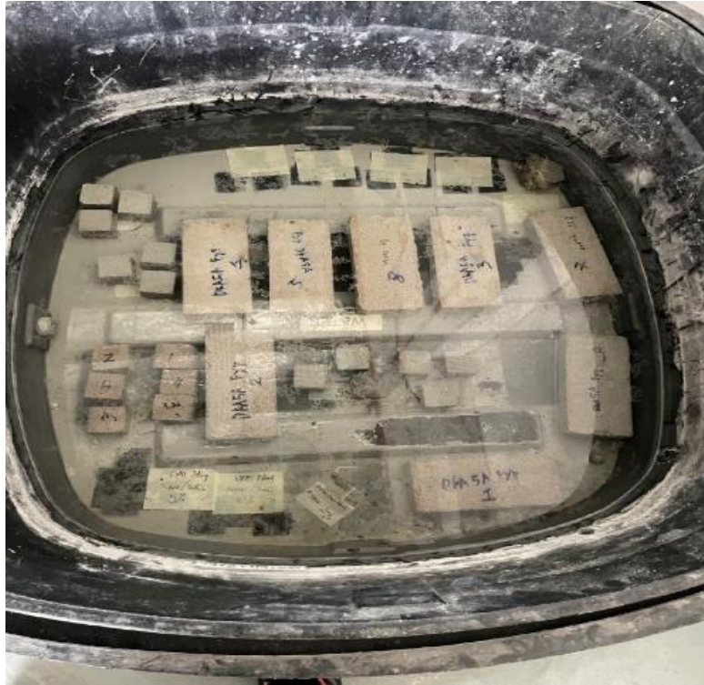
Rajah 3.6: Ujian peyerapan air yang dibuat di makmal Polteknik Shah Alam
