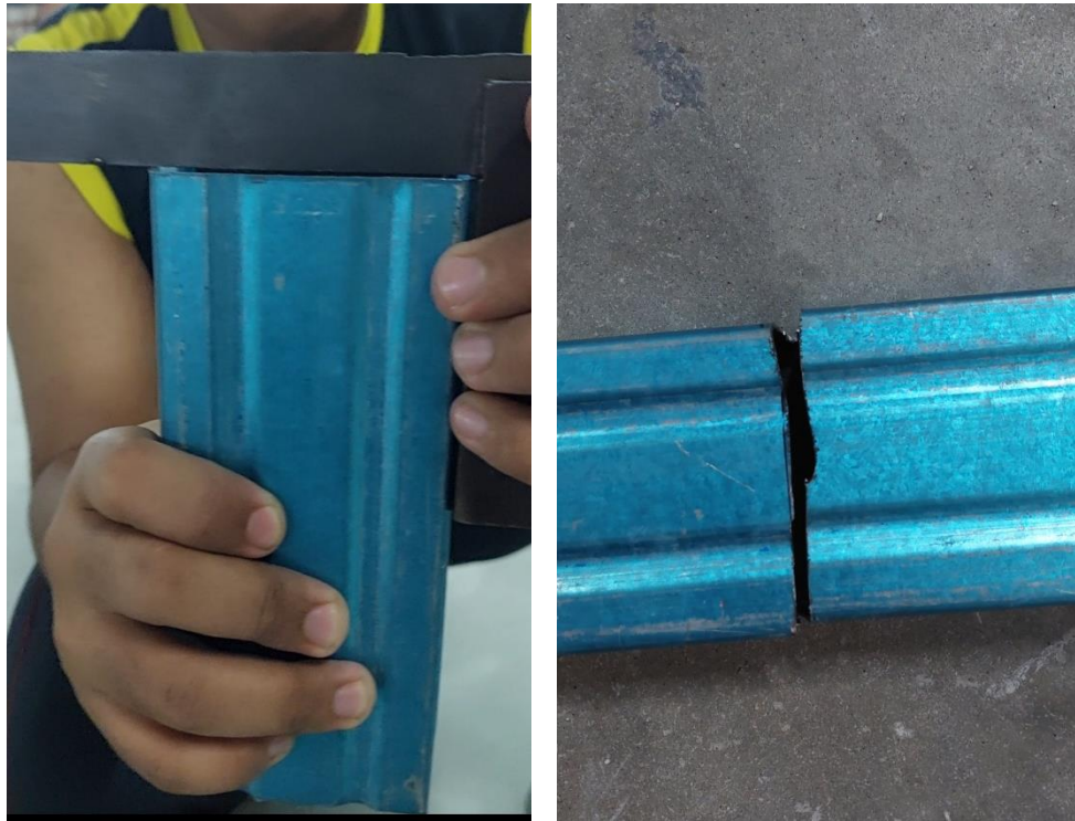
Rajah 4.4 : Perbandingan Kelurusan Dengan Produk Kami(Kiri) Dan Mesin Canai(Kanan)
