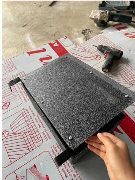
Rajah 3.10.13 Permukaan pintu produk yang telah diskru
