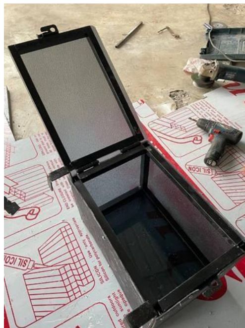
3.10.14 Rangka produk yang telah siap dipasang polycarbonate dari pandangan atas
