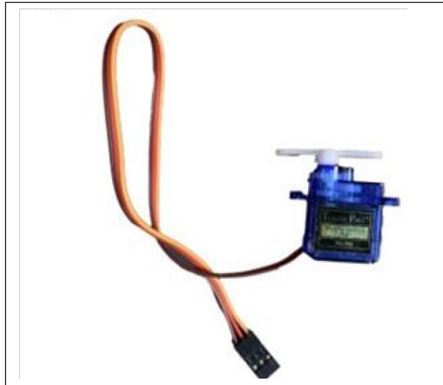
Rajah 5 : Servo Motor SG90 (180)
