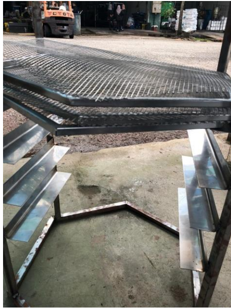
Plat-plat besi tahan karat yang telah dipaterikan pada kerangka produk.
