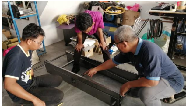
Rajah 3.2.3.3 Proses mencantumkan besi menggunakan Welding Mig
