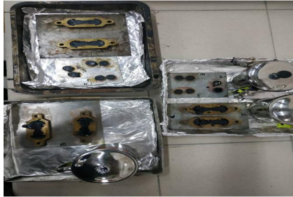
Rajah 1.3 Campuran asfalt dan plastik
