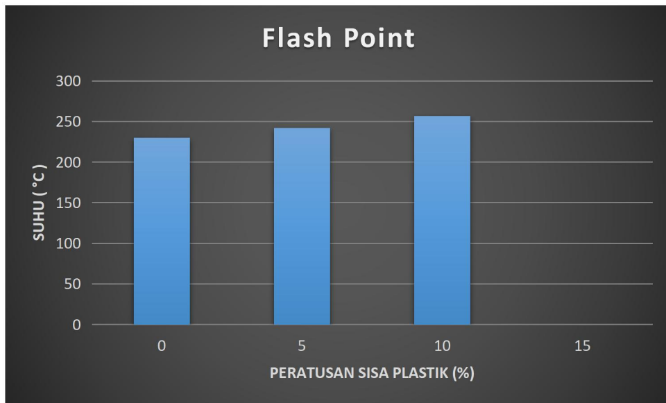
Graf 4.5 Ujian “flash point” pada sampel (0%, 5%, 10%, 15%)
