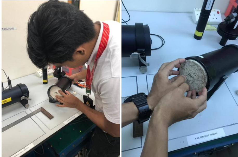
Rajah 3.6 Memasukkan sampel ke dalam Impedance Tube
