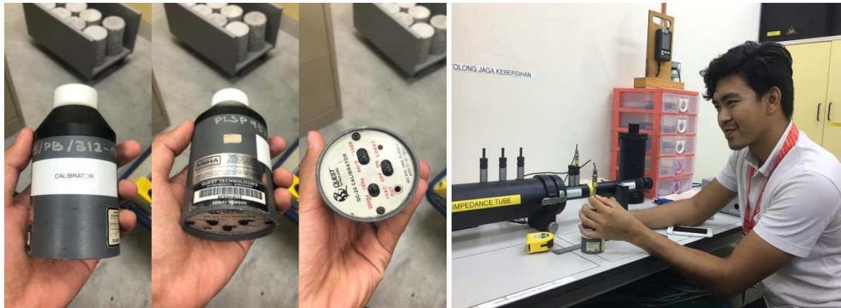
Rajah 3.3 Alat Kalibrasi Mikrofon
