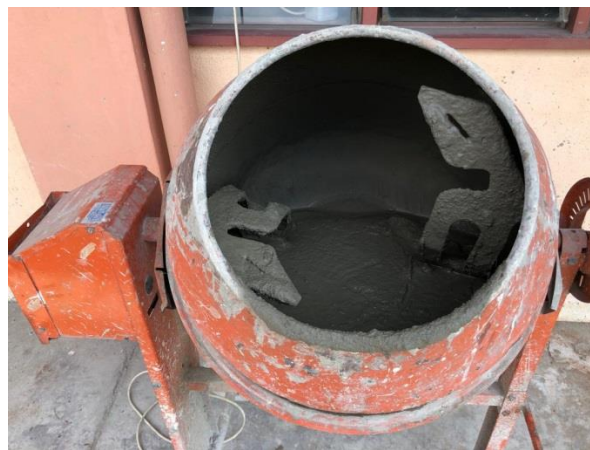
Rajah 3.4.1 iv : Proses campuran sebatian dalam mesin mixer
