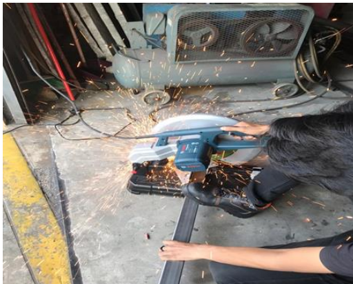
RAJAH 3.7.2 menunjukkan kerja-kerja pemotongan besi mengikut saiz dan ukuran yang dikehendaki
