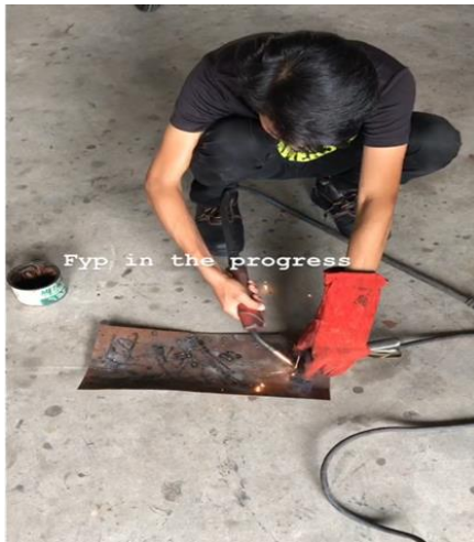
RAJAH 3.7.3 proses-proses mengimpal untuk menyambungkan rangka-rangka projek. Proses yang digunakan adalah kimpalan mig.
