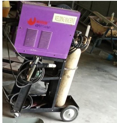
RAJAH 3.7.3 proses-proses mengimpal untuk menyambungkan rangka-rangka projek. Proses yang digunakan adalah kimpalan mig.
